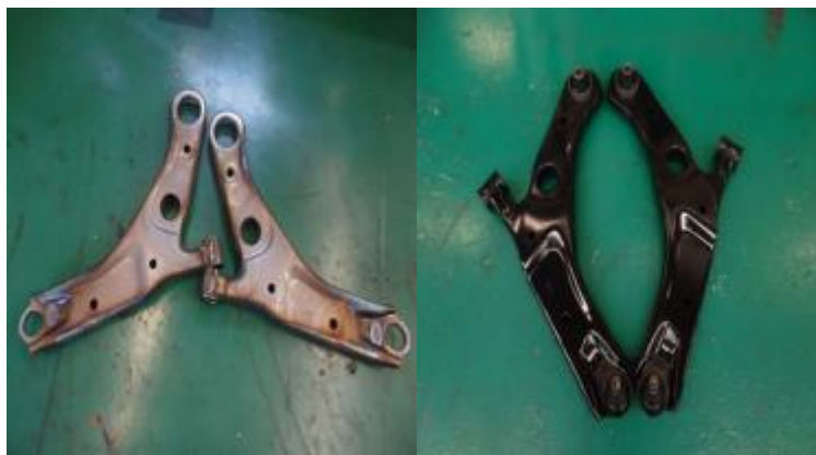
Figura 2.5 Proceso de soldadura, pintura e inserción de bujes
